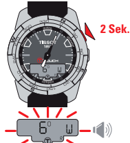
Einstellmodus und Anzeige der magnetischen Deklination
